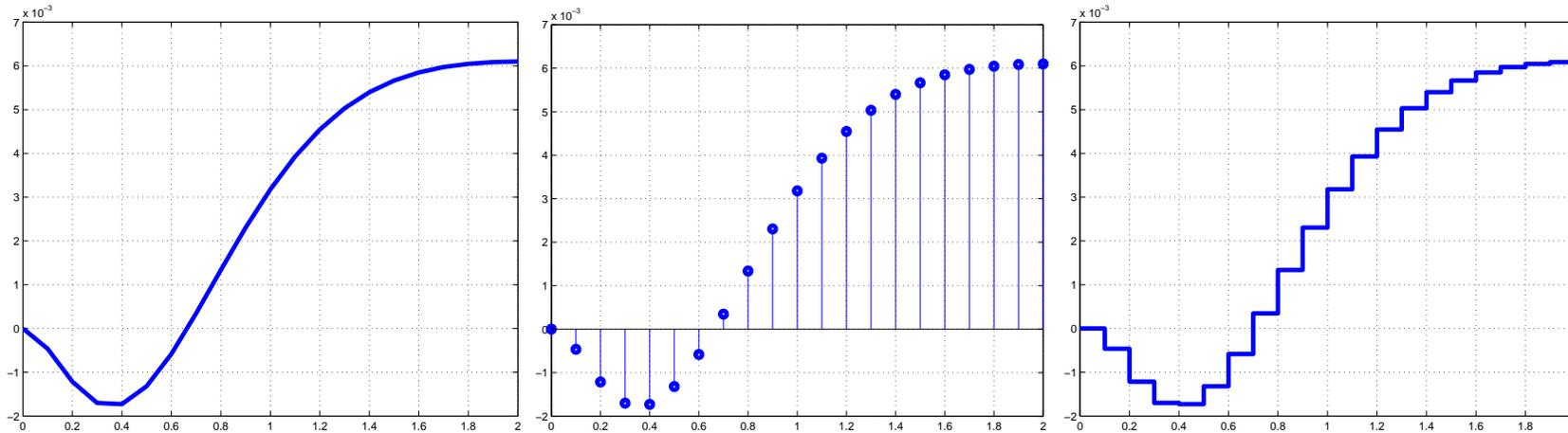
Las figuras arriba ilustran el proceso de muestreo con periodo de  $T = 0.1[s]$  (segunda figura de izquierda a derecha) y la reconstrucción a través del mantenedor (tercera figura de izquierda a derecha).
