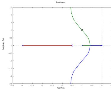
Figura 3: Lugar de raíces de la planta compensada
