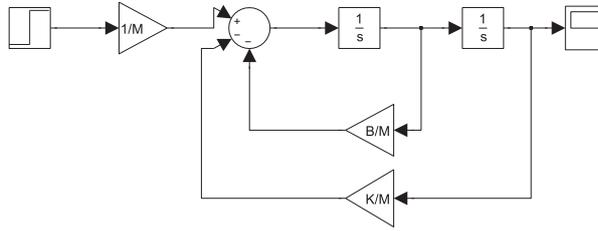
Figura 4: Arreglo simulink del problema 3
