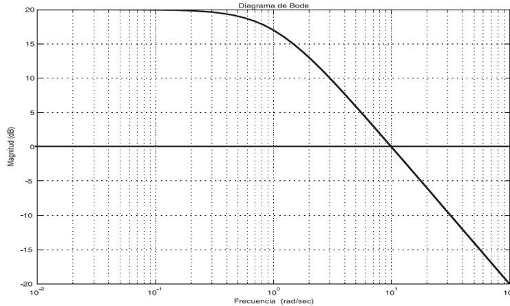
Figura 1: Resultado de la identificación de un motor de CC
