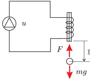
Figura 1: Diagrama del levitador magnético
